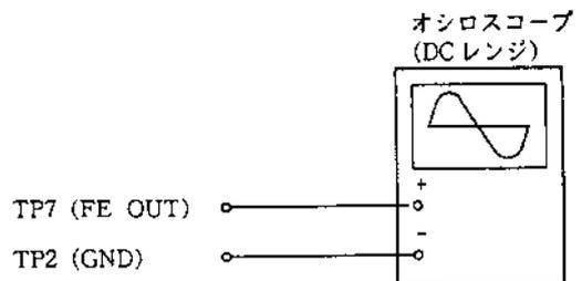
1. オシロスコープをテストポイントTP7 (FE OUT) とTP2 (GND) に接続する。
