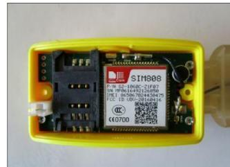
Осторожно отвинтите два винта, с помощью отвертки, входящей в комплект поставки. Всегда используйте только предлагаемую отвертку. Аккуратно откройте пластиковую крышку, обращая внимание на кабели аккумулятора и вставьте SIM-карту, как показано на фотографии выше. Затем плотно закройте пластиковую крышку и прикрутите два винта. Обязательно плотно закройте пластиковую крышку, чтобы трекер был водонепроницаемым.
