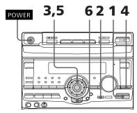
**1** Appuyez de façon répétée sur TUNER/BAND jusqu'à ce que la gamme souhaitée apparaisse sur l'afficheur.
