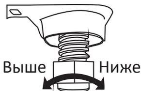
Обеспечьте ровное и устойчивое положение стиральной машины. Ослабьте стопорную гайку гаечным ключом и поворачивайте ножку вручную до полного контакта с полом. Прижмите ножку одной рукой, а другой затяните гайку. После этих действий еще раз нажмите на корпус машины по четырем углам последовательно, чтобы убедиться, что она правильно выровнена. Если это все еще не так, повторите действия, описанные выше.
