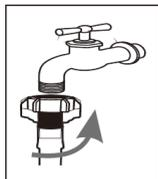
Впускной клапан горячей воды
