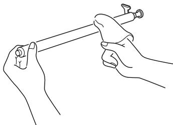
**5** Осторожно протрите стеклянную поверхность сканера сухой мягкой тканью.
