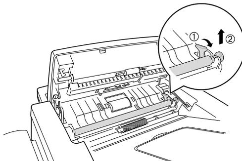
**4** Протрите поверхность ролика слегка смоченной мягкой тканью.
