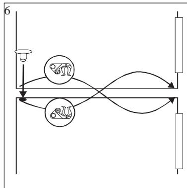
7. Установите верхнюю дверь на место и закрепите стержень верхней петли. Установите нижнюю дверь на место. Установите стержень нижней петли в противоположное положение. Установите нижнюю петлю на место. Возможный зазор следует удалить посредством регулирования высоты нижней петли прилагаемым к холодильнику регулировочным ключом. Зафиксируйте положение двери контрящей гайкой. Переставьте защитную пластину вентиляционной решётки и установите решётку обратно на место.
