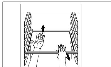
Нижнее дверное отделение, а также полку над отделением для хранения овощей не следует переставлять, так как они обеспечивают правильную циркуляцию воздуха внутри холодильника. Полки с поднятым краем следует устанавливать поднятым краем к задней стенке холодильника, для того чтобы хранимые продукты не касались панели охлаждения.
