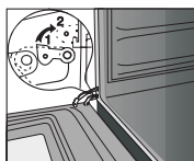
1 Шарнир дверцы при нормальном использовании
