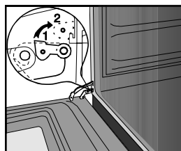
1 Шарнир дверцы при обычном использовании
