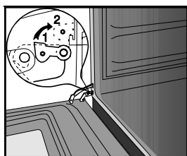
1 Шарнир дверцы при обычном использовании
