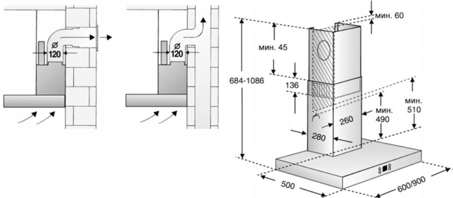
Отводимый воздух подается вверх через вентиляционную шахту или непосредственно через наружную стену за пределы помещения.
