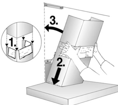
13. Выдвиньте верхнюю секцию и прикрепите ее сбоковых сторон двумя винтами к монтажным скобам.
