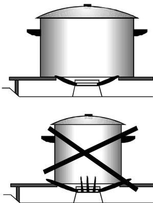
Чтобы обеспечить максимальную эффективность использования пламени, пламя не должно выходить за пределы размеров дна посуды, которая стоит на конфорке, т.е. размер дна посуды должен быть таким, чтобы полностью закрывалось пламя.
