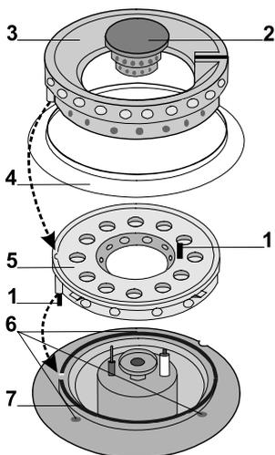
После чистки поверхностей прибора обратите внимание на то, чтобы крышка была правильно установлена на горелку. В противном случае невозможно будет пользоваться электроподжигом. Перед установкой горелка и крышка горелки должны быть абсолютно сухими.
