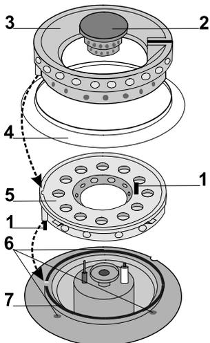
Головку горелки **5** на корпус горелки **7**, а также крышку горелки **3** на головку горелки **5** укладывают таким образом, чтобы **препятствующий** **перекручиванию** **штифт** или **выступ** **ложился** в **отверстие** или **выемку**.
