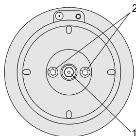
Снимите решетку и крышку горелки.
