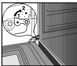
1 Петля дверцы при нормальном использовании
