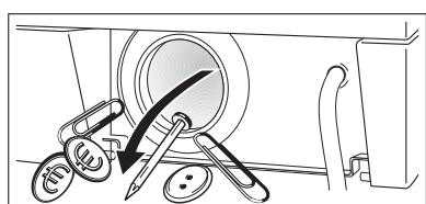
5. Проверьте, нормально ли проворачивается рабочее колесо насоса, которое расположено в самой задней части корпуса насоса.
