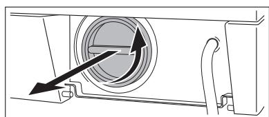
4. Удалите из корпуса и с рабочего колеса насоса весь попавший туда сор, например ворсинки от тканей.
