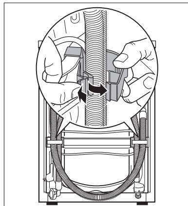
2. Одним рывком снимите с машины оба держателя шлангов.
