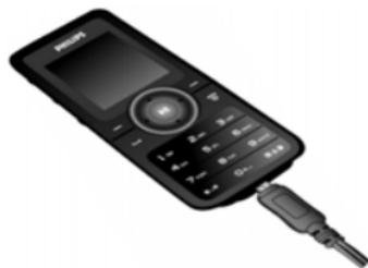
Символ аккумулятора указывает состояние зарядки. Во время зарядки будут прокручиваться соответствующие индикаторы. Для полной зарядки аккумулятора понадобится примерно 3 часа. Когда все четыре полоски отображаются постоянно, аккумулятор заряжен полностью. После этого можно отключить зарядное устройство.
