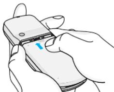
3. Скользящим движением закройте заднюю крышку до щелчка.
