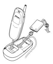
Одновременно с установленной в телефон батареей в настольном зарядном устройстве можно заряжать запасную батарею. Для этого установите ее в гнездо зарядного устройства, как показано на рисунке.
