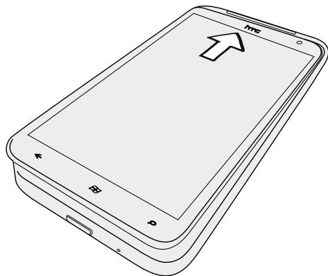
3. Нажмите на телефон вниз, чтобы зафиксировать крышку. Фиксация задней крышки на месте подтверждается щелчком.
