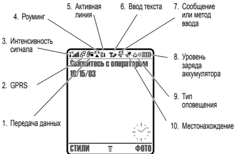
**1. Индикатор передачи данных** показывает состояние соединения и передачи данных. Индикатор может показывать:
