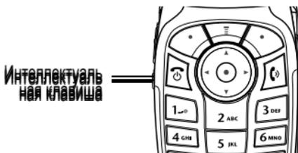
использовать для инициации и завершения вызовов, включения и отключения функций, а также для вызова справочника. Клавиша Smart обычно выполняет функцию правой программной клавиши (⏏).
