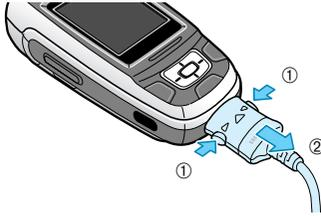
**Примечание.** Если требуется снять аккумулятор с телефона во время зарядки, необходимо предварительно отключить зарядное устройство; в противном случае возможно повреждение телефона.
