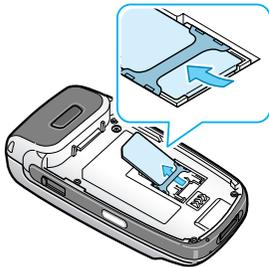
4. Установите аккумулятор так, чтобы выступы на его торце вошли в вырезы в нижней части телефона.
