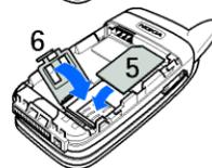
Установите аккумулятор (7). Следите за расположением контактов аккумулятора. Пользуйтесь только фирменными аккумуляторами Nokia. См. раздел [Проверка подлинности аккумуляторов Nokia](#) на стр. 143.
