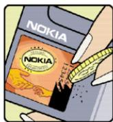
3. Соскоблите покрытие сбоку от голограммы - откроется код (20 цифр), например, 12345678919876543210. Поверните аккумулятор цифрами вверх. Код (20 цифр) начинается в верхней строке и продолжается в нижней.
