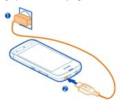
3 После отображения индикатора полного заряда отсоедините зарядное устройство от телефона, а затем отключите его от розетки.
