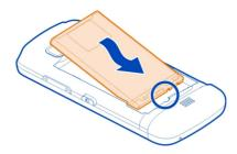
8 Чтобы установить панель на прежнее место, направьте верхние стопорные защелки в соответствующие гнезда и нажимайте, пока панель не встанет место.
