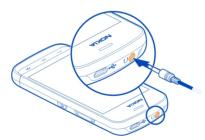
Не подключайте аппаратуру, которая формирует выходной сигнал, поскольку в результате устройство может оказаться повреждено. Не подключайте источники напряжения к разъему AV Nokia. При подключении к разъему AV Nokia внешнего устройства или минигарнитуры, отличных от рекомендованных корпорацией Nokia для данного устройства, уделите особое внимание уровню громкости.
