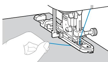
► По завершении шитья машина автоматически прошивает усилительные стежки, а затем останавливается.
