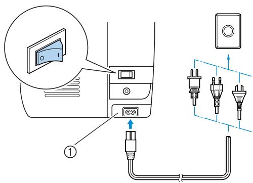
① Гнездо подключения сетевого шнуря
