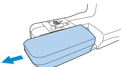
► При снятой плоской платформе становится возможным шитье с использованием функции “свободный рукав”.
