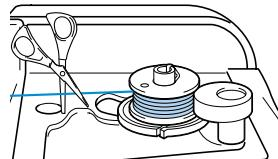
17 Сдвиньте вал устройства намотки шпульки влево.
