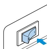
► При включении питания машины загорается лампочка подсветки и включается ЖК-индикатор.
