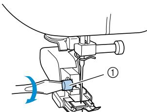
① Винт крепления адаптера лапки
