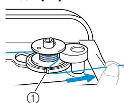
① Прорезь в седле устройства намотки шпульки (со встроенным устройством обрезки)
