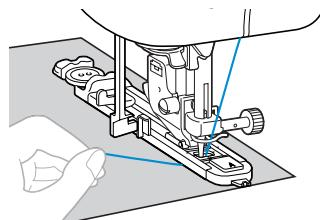
► По завершении выметывания петли машина прошивает усилительные стежки, а затем останавливается.
