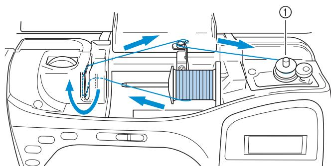
① Устройство намотки шпульки
