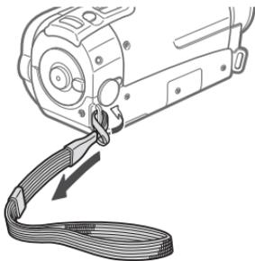
Пропустите крепящий конец наручного ремня через задний кронштейн видеокамеры, затем пропустите наручный ремень сквозь петлю и затяните его.
