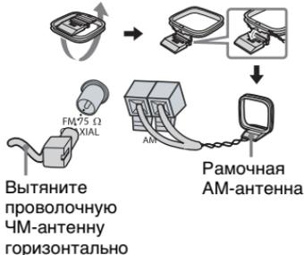
Во избежание ловли шумов, антенны должны находиться вдали от кабелей колонок, силового кабеля и кабеля USB.
