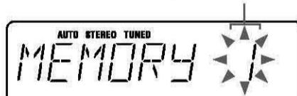
3 Нажмите повторно кнопку +/- [11] для выбора нужного номера предварительно установленной станции.
