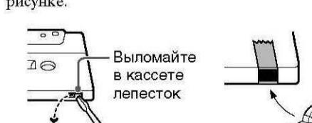
Для последующего использования кассеты для записи закройте отверстие на месте выломанного лепестка липкой лентой.
