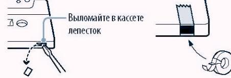
Для последующего использования кассеты для записи закройте отверстие на месте выломанного лепестка липкой лентой.
