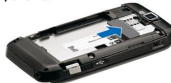
4. Установите аккумулятор. Совместите контакты аккумулятора с соответствующими контактами отсека питания и вставьте в направлении стрелки.
