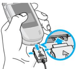
1. В соответствии с направлением стрелки, показанной на рисунке, вставьте штепсельную вилку, находящуюся на адаптере батареи в гнездо, расположенное на нижней части телефона, до щелчка.
